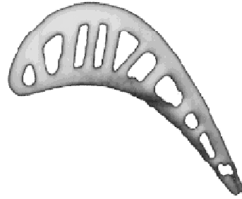
Abbildung 4: (a) Prinzipskizze zur Computertomographie (CT). Das Objekt wird aus mehreren Richtungen durchleuchtet. Aus der vom Detektor gemessenen Strahlungsintensität wird dann das Tomogramm berechnet. (b) Schnitt durch eine im Feingussverfahren hergestellte Turbinenschaufel aus Aluminium. Die CT-Aufnahme zeigt die komplexe innere Struktur der Kühlkanäle.
